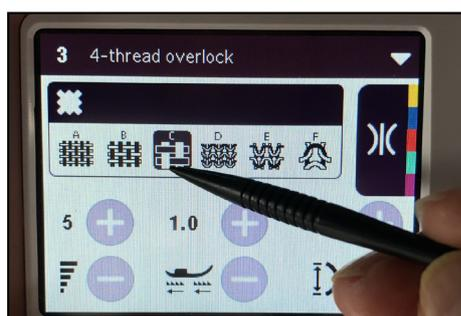
Si vous souhaitez apporter des ajustements aux fils des boucleurs, vous pouvez utiliser le contrôle précis de l'enfilage. Cette fonction brevetée sur votre AMBER™ Air S|600 vous permet d'ajuster les fils de surjet pour une formation de points parfaite le long des bords du tissu.
